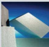
Matériau éco-responsable, le Styropor®, est très peu gourmand en énergie et matières premières. C'est un produit parfaitement compatible à l'environnement. Ce matériau est à structure cellulaire fermée formée à 98% d'air qui lui confère des qualités d'isolation thermique et d'étanchéité à l'air et à l'eau. C'est aussi un matériau inerte qui n'a aucun pouvoir nutritionnel. Il ne peut donc pas être agressé par les champignons, les bactéries et les petits animaux. .
